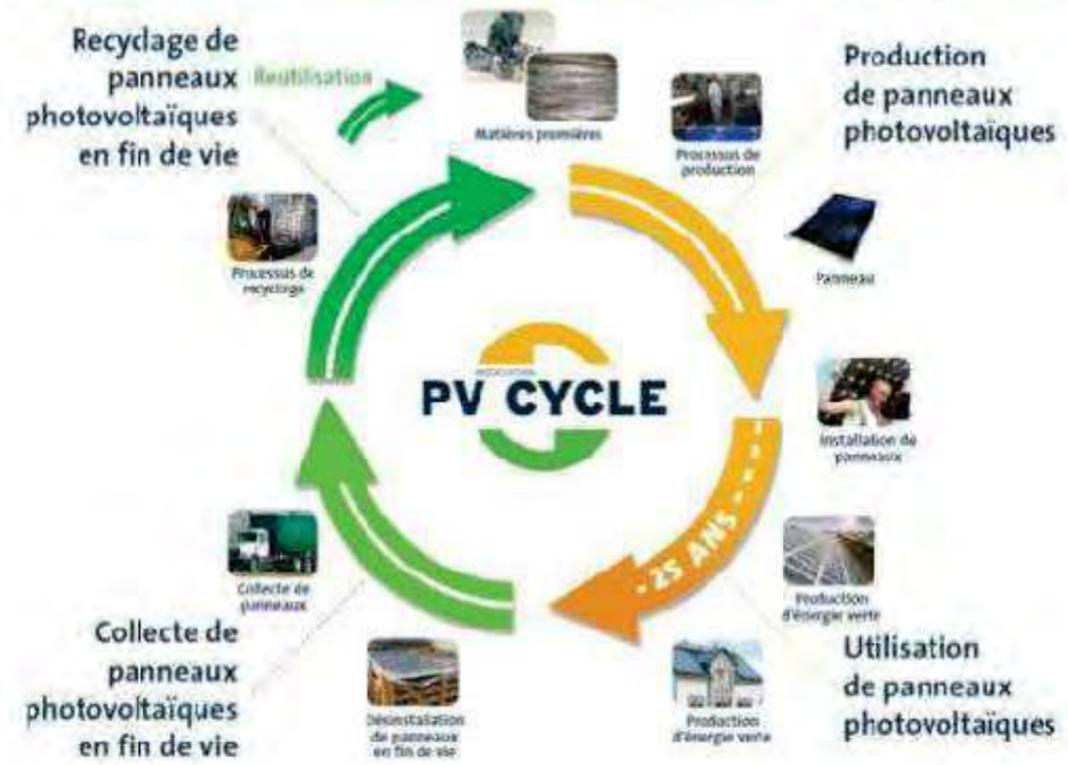
Une fois que le panneau photovoltaïque a été séparé de son cadre aluminium et de sa boîte de jonction, il sera broyé afin d'obtenir des fractions qui seront ensuite triées à l'aide de différentes méthodes (vibration, tamisage, courant de Foucault, tri optique, etc)
